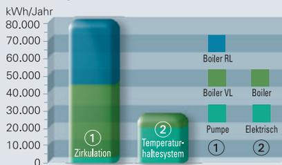
Nur 36 % Energiebedarf aufgrund halber Rohrlänge und geringerer Wärmeverluste
